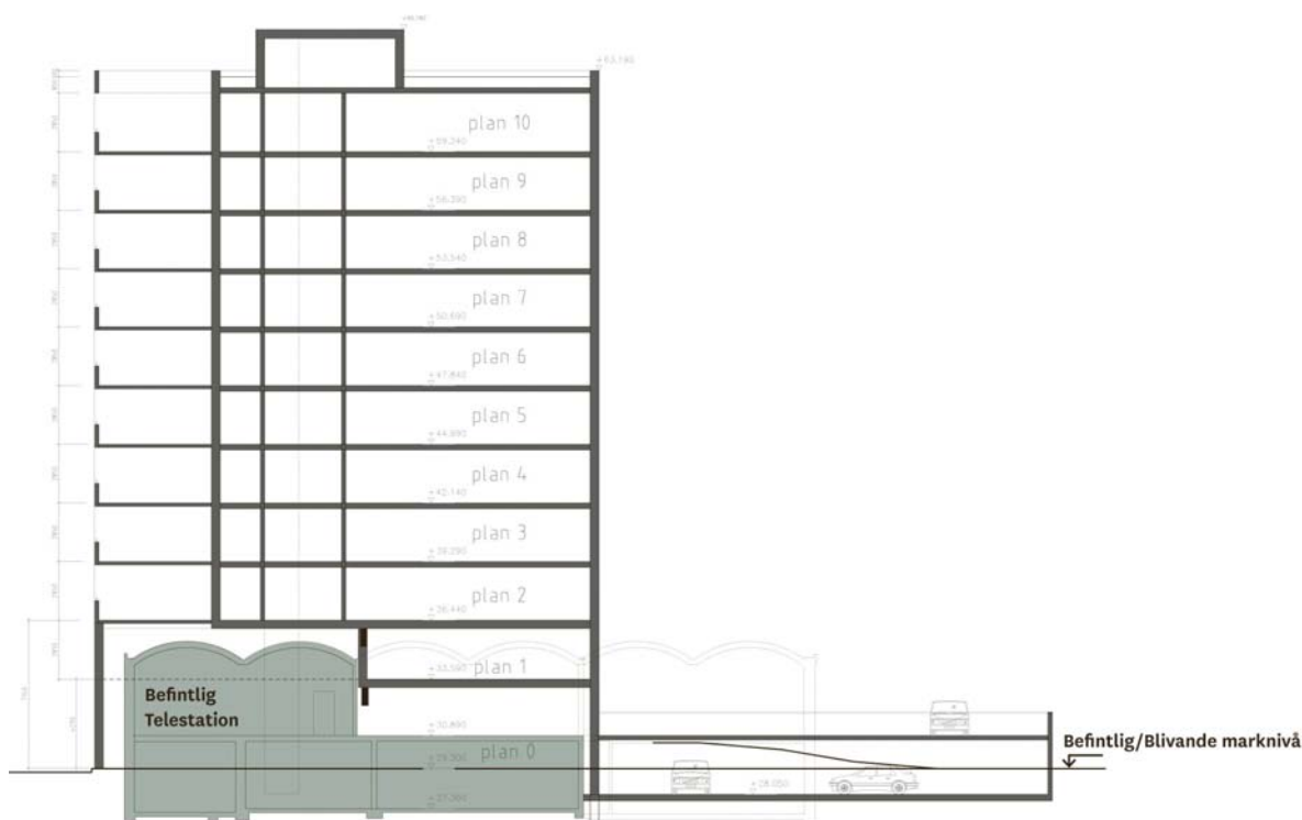
Bild 11 Principsektion av den nya bebyggelsens förhållande till telestationen som delvis bibehålls i sin nuvarande form och byggs in i den det nya bostadshuset. Skala 1:500. Skiss: Tengbom.
