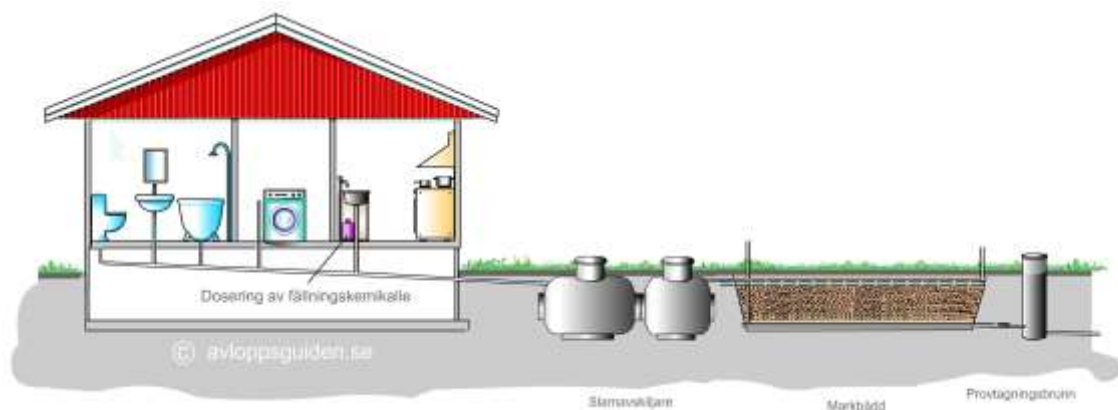
Bild 2: Kemisk fällning samt markbädd. (källa: www.avloppsguiden.se )
