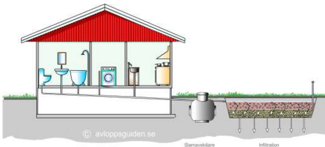
Bild 1: Infiltrationsanläggning för WC- och BDT-avloppsvatten. (källa: www.avloppsguiden.se )
